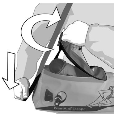
Wenn die Tasche sich nicht wie oben beschrieben öffnen lässt (z.B. beim Stehen auf einer Leiter), öffnen Sie den Klettverschluss zunächst teilweise mit zwei Fingern auf einer Seite. Öffnen Sie dann die Tasche vollständig, indem Sie an der gelben Schlaufe ziehen und so die Luftversorgung aktivieren.
